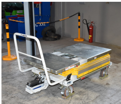
液壓式升降工作台－承載能力 1,000 kg
